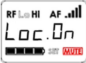
송신기의 LOCK 설정시 송신기의 전원이나 설정을 변경하지 못하도록 하는 기능으로 MUTE 상태에서 SET KEY를 3초이상 길게 누르면 LOCK 설정을 ON / OFF 할 수 있습니다.
